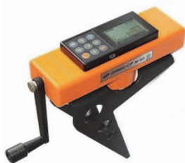
Рисунок 7 – Прибор – ОНИКС-1.СР НПП «Интерприбор» (Россия, г. Челябинск), реализующий механический метод неразрушающего контроля прочности бетона – метод скалывания ребра.
