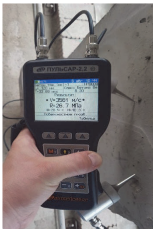
Рисунок 8 – Прибор – ПУЛЬСАР-2.2 НПП «Интерприбор» (Россия, г. Челябинск), реализующий механический метод неразрушающего контроля прочности бетона – ультразвуковой метод (УЗК). Общий вид прибора (слева), показания электронного блока (справа)
