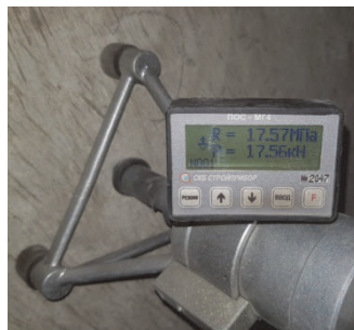
Рисунок 6 – Прибор – ПОС-МГ4.ОД СКБ «Стройприбор» (Россия, г. Челябинск), реализующий механический метод неразрушающего контроля прочности бетона – метод отрыв со скалыванием.
