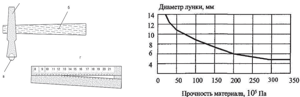
Рисунок 2 – Прибор – Молоток Физделя (шариковый молоток), реализующий механический метод неразрушающего контроля прочности бетона – метод пластической деформации. Общий вид прибора (слева), тарировочные кривые для молотка Кашкарова (справа)
