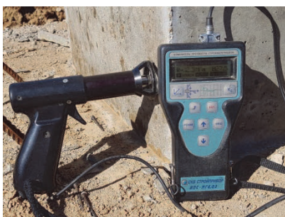
Рисунок 4 – Прибор – ИПС-МГ4.03 СКБ «Стройприбор» (Россия, г. Челябинск), реализующий механический метод неразрушающего контроля прочности бетона – Метод ударного импульса. Общий вид прибора (слева), показания электронного блока (справа)
