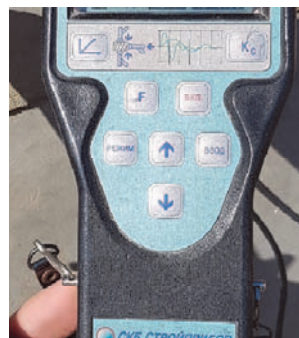
Рисунок 4 – Прибор – ИПС-МГ4.03 СКБ «Стройприбор» (Россия, г. Челябинск), реализующий механический метод неразрушающего контроля прочности бетона – Метод ударного импульса. Общий вид прибора (слева), показания электронного блока (справа)
