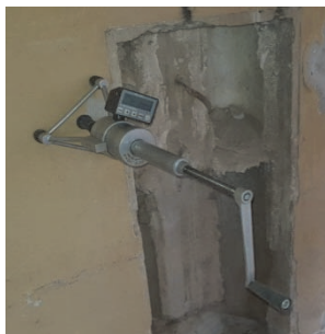
Рисунок 6 – Прибор – ПОС-МГ4.ОД СКБ «Стройприбор» (Россия, г. Челябинск), реализующий механический метод неразрушающего контроля прочности бетона – метод отрыв со скалыванием.
