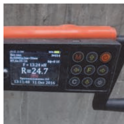
Рисунок 7 – Прибор – ОНИКС-1.СР НПП «Интерприбор» (Россия, г. Челябинск), реализующий механический метод неразрушающего контроля прочности бетона – метод скалывания ребра.
