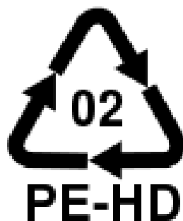
Рисунок 5 - Полиэтилен высокой плотности и низкого давления
