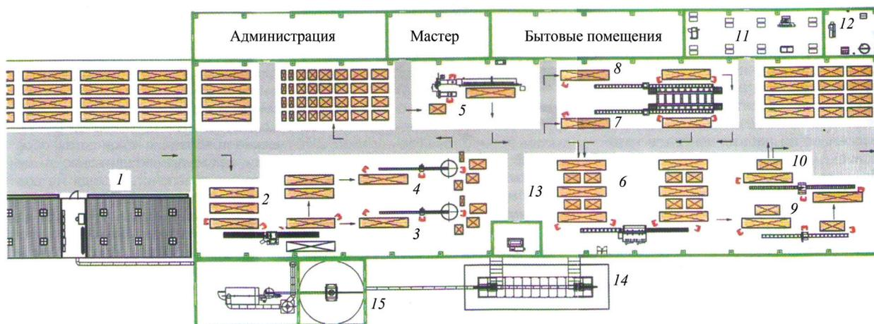
Технологическая планировка цеха для производства оконного бруса объемом 5 717 м<sup>3</sup> в год: 1 — сушильные камеры; 2, 9 — круглопильные станки; 3, 4 — торцовочные станки; 5 — линия сращивания заготовок по длине; 6 — четырехсторонний продольно-фрезерный станок; 7, 8 — прессы; 10 — участок упаковки готового клееного оконного бруса в пленку; 11 — инструментальный участок; 12 — компрессорная установка; 13 — установка измельчения; 14 — система аспирации; 15 — котельная установка
