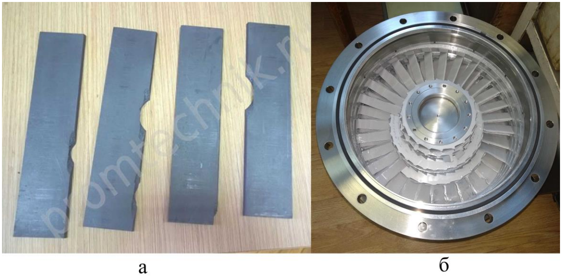
Рис. 1.8. Примеры отказов вакуумных насосов: а – отказ пластинчато-роторного форвакуумного насоса из-за износа пластин; б – отказ турбомолекулярного вакуумного насоса из-за износа несущего вала и опорного подшипника.
