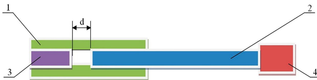
Рис. 2. Принципиальная схема волоконно-оптического датчика.
