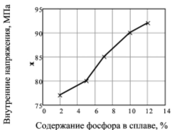
Рис. 6. Зависимость показателей внутренних напряжений от содержания фосфора в покрытии
