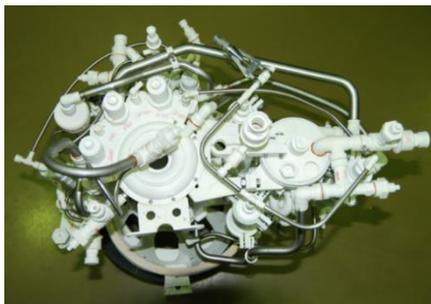
**Рис. 1. Пример использования в 3D-макете из пластика металлических трубопроводов и крепежа для соединения отдельных узлов и агрегатов**
