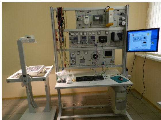
Рис. 3. Лабораторный комплекс с макетом солнечного модуля
