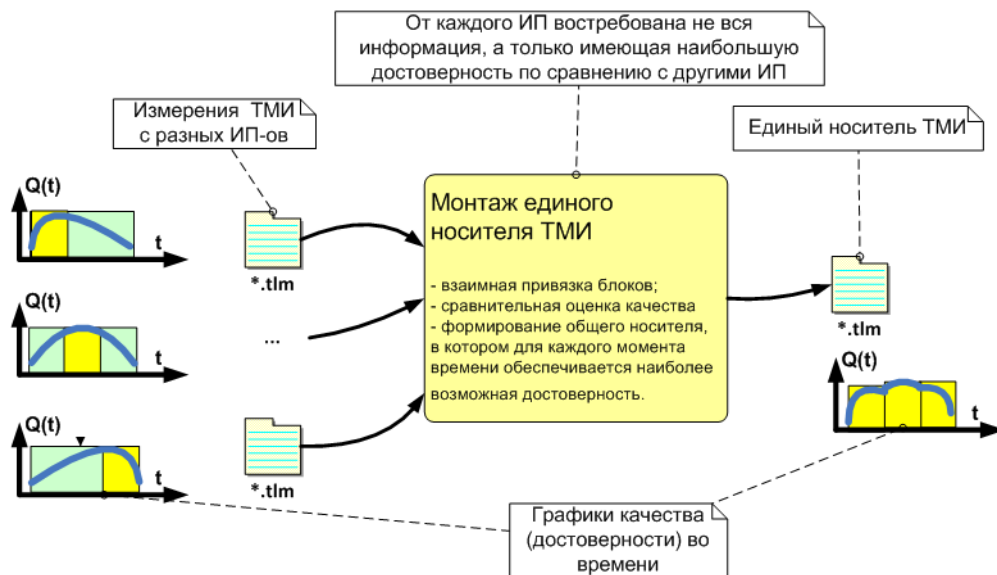
Рисунок 1. Принцип формирования единого носителя ТМИ
