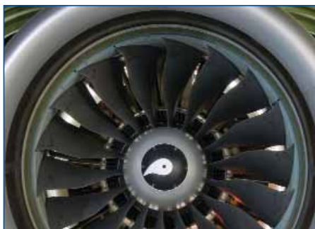
Рис. 4. Редукторный ТРДД Pratt & Whitney (geared turbofan) GTF
