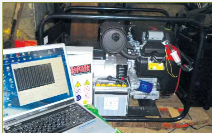
Рис. 4 Отработка элементов оригинальной топливной системы на макете
