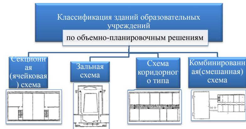
В секционной схеме ярко выражена группировка помещений, завязанная вокруг лестнично-лифтового узла, поэтому планировочные решения могут быть чрезвычайно разнообразны. Преобладает вертикальная составляющая в облике такого здания, подразумевающая собой многоэтажность.
