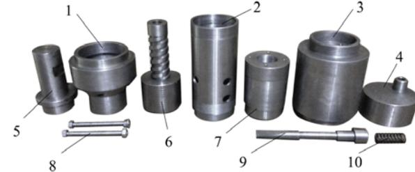
1 – корпус камеры холостого хода; 2 – цилиндрический корпус камеры рабочего хода; 3 – корпус распределительной камеры; 4 – корпус сетевой камеры; 5 – хвостовик; 6 – ступенчатый ударник; 7 – втулка; 8 – шпильки; 9 – стержень; 10 – пружина
