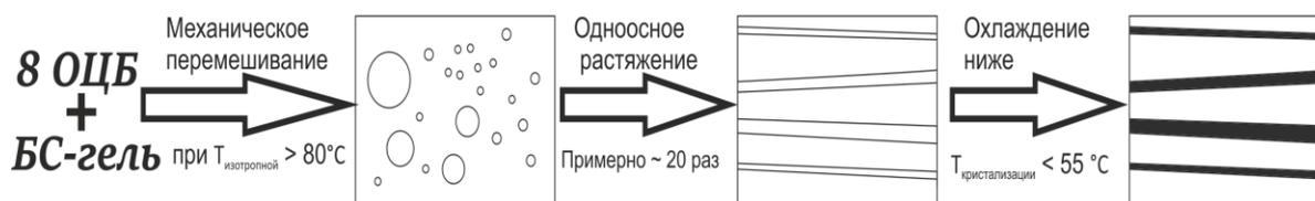
Рис. 3. Схема получения ЖК-композитов
