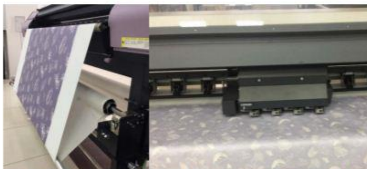
Рис.2 – Печать принта на трансфер-бумагу на плоттере MIMAKI, инжиниринговый центр РГУ им. А. Н. Косыгина
