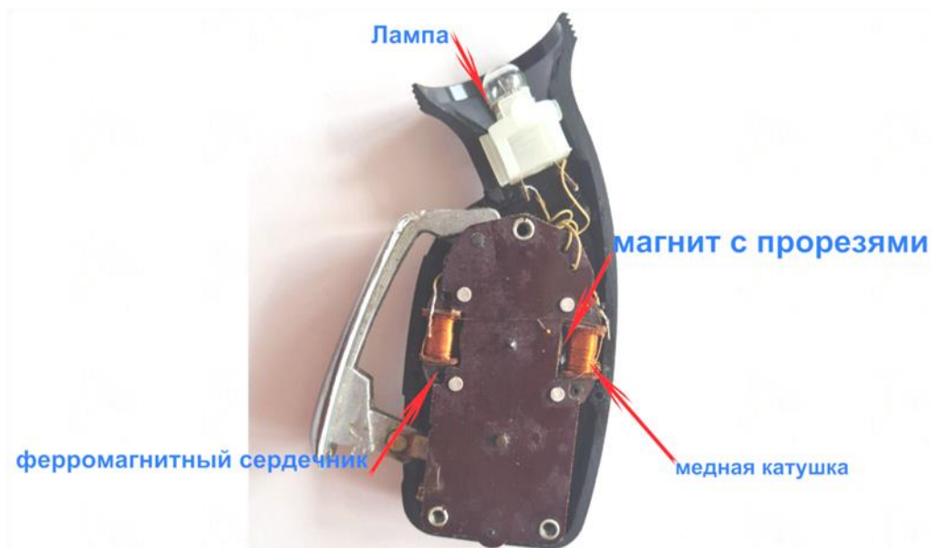
Рис. 2. Конструкция устройства
