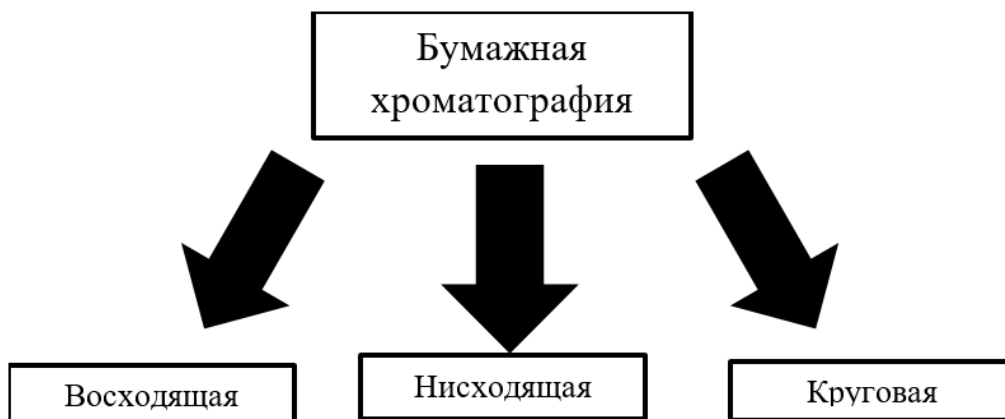
Рис. 2. Классификация бумажной хроматографии по технике выполнения
