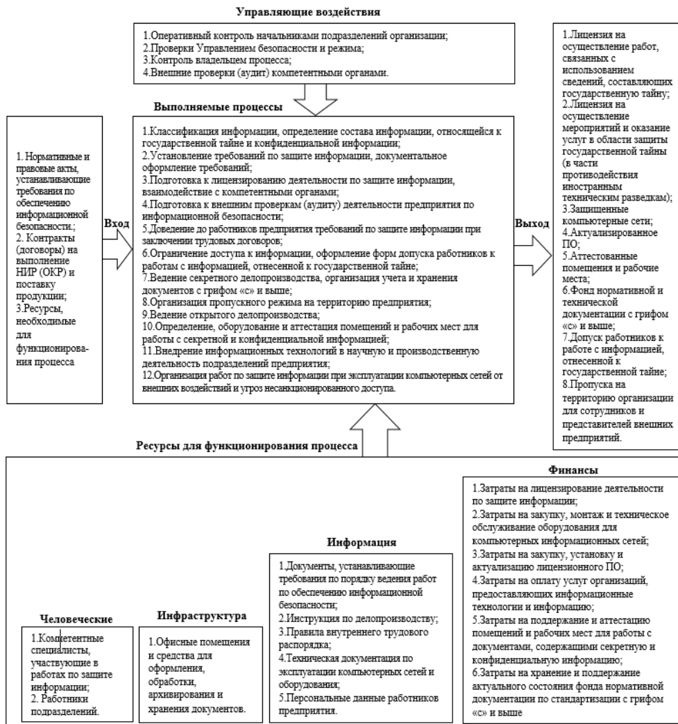
Рисунок 3 - Схема процесса по обеспечению информационной безопасности на предприятии РКО
