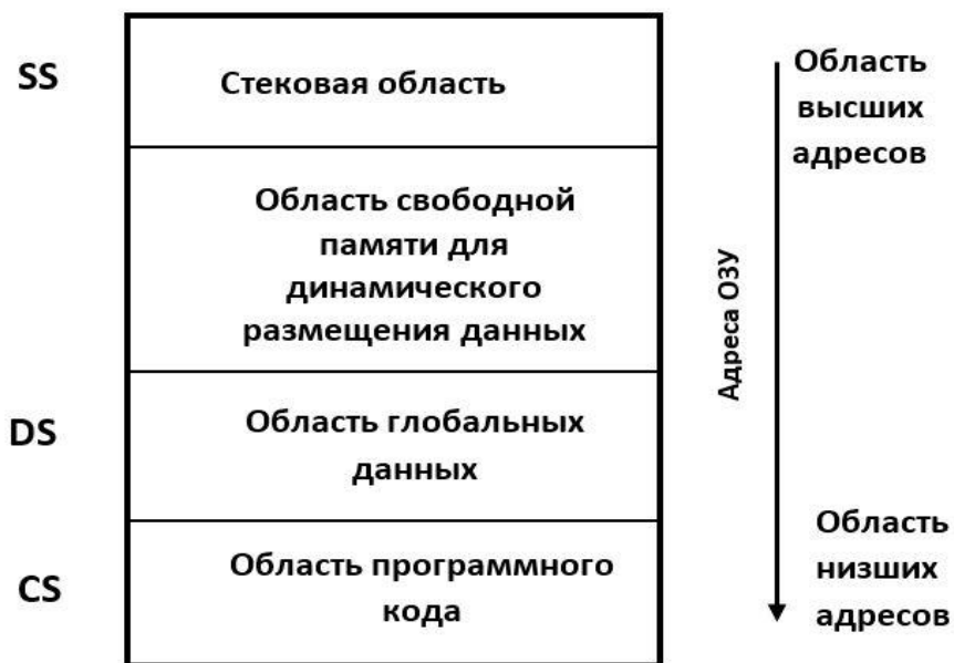
Рисунок 10 – Структура распределения памяти под прикладную программу
