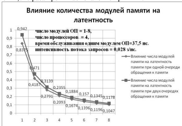
Рис. 2 – Влияние числа модулей памяти на латентность при одной и двух очередях обращения к памяти
