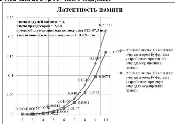
Рис. 4 – Влияние числа ЦП на латентность памяти при одной и двух очередях обращения к памяти
