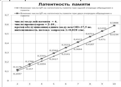
Рис. 3 – Влияние числа ЦП на латентность памяти при одной и двух очередях к памяти
