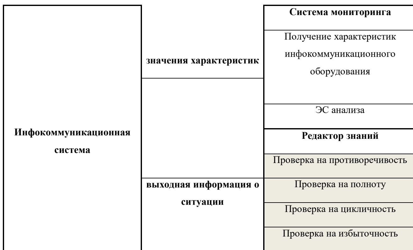
Рисунок 4.5 – Типовая структурная схема взаимодействия редактора знаний с системой мониторинга инфокоммуникаций
