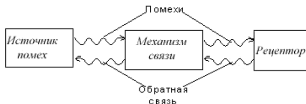
Рисунок 1.1 – Элементарная модель влияния помех в тракте передачи
