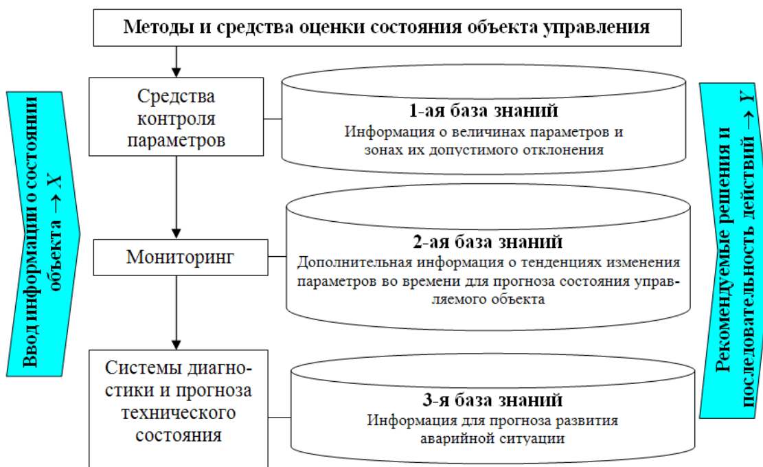
Рисунок 4.1 – Структуризация контролируемых объектов при оценке их состояния
