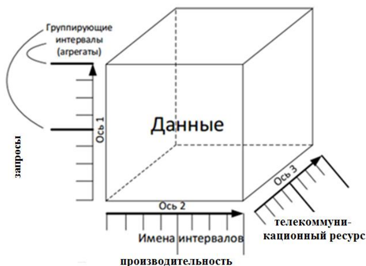
Рисунок 4.4 – Типовая структура многомерного куба для хранения и обработки данных о состоянии инфокоммуникационной системы
