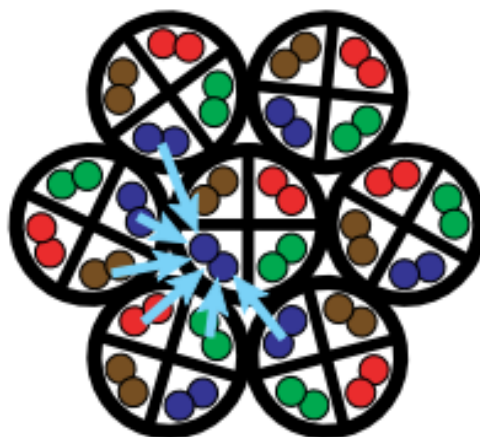
Рисунок 1.4 – Модель 3 механизма формирования межкабельной переходной помехи в кабеле с сердечником
