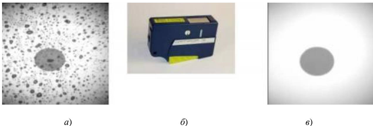
Рисунок 2.5 – Результаты очистки торца волокна: а) осмотр торца; б) очистка; в) повторный осмотр
