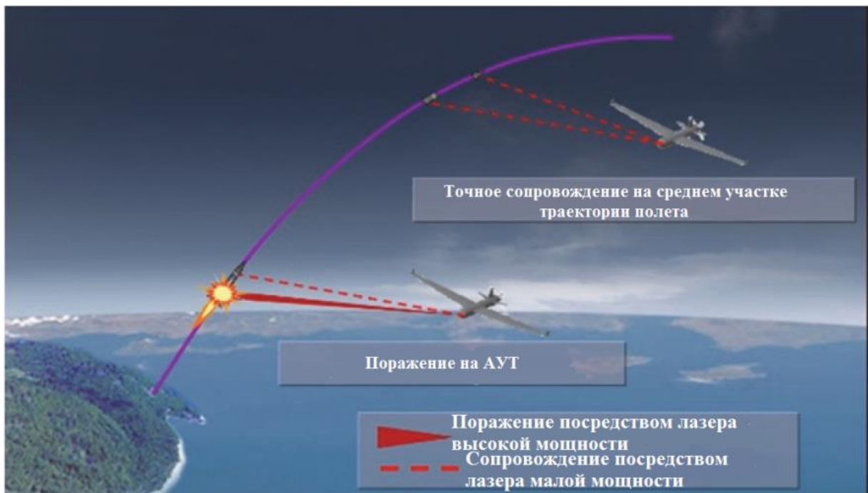
Рисунок 5. Использование лазерных систем, размещенных на БЛА, для перехвата на АУТ и точного сопровождения на среднем участке траектории полета
