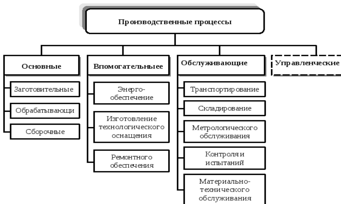
Рисунок 2 – Классификация производственных процессов в организации
