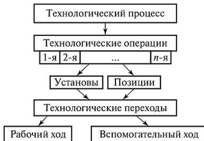
Рисунок 1 – Структура технологического процесса организации
