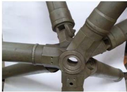
Рисунок 3.6 – Трубы из композиционного материала АІ-В в составе сборочного узла
