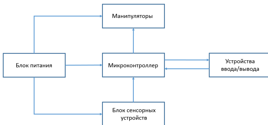
Рисунок 1 – Структурно-функциональная схема мехатронного робототехнического устройства для реабилитации пациентов с избыточным весом
