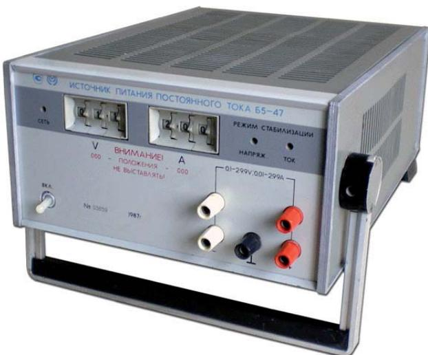
Рис. 2. Внешний вид источника питания постоянного тока Б5-47.
