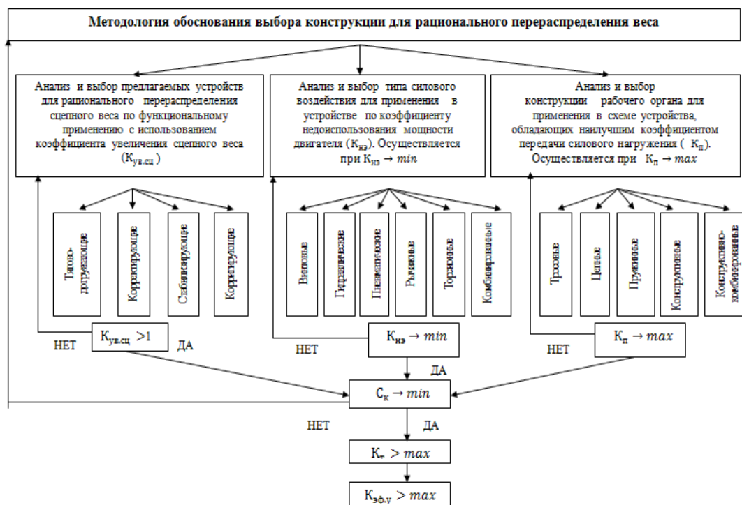
Рисунок 1-Алгоритм синтезирования конструкции тягово-догружающих устройств
