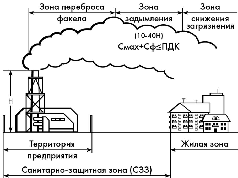
**Рисунок 7 - Распределение загрязнений в зависимости от удаления от источника**
