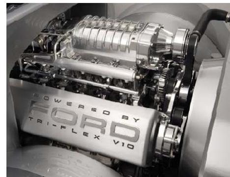
Рисунок 1 - Водородный поршневой двигатель компании «Ford Motor»
