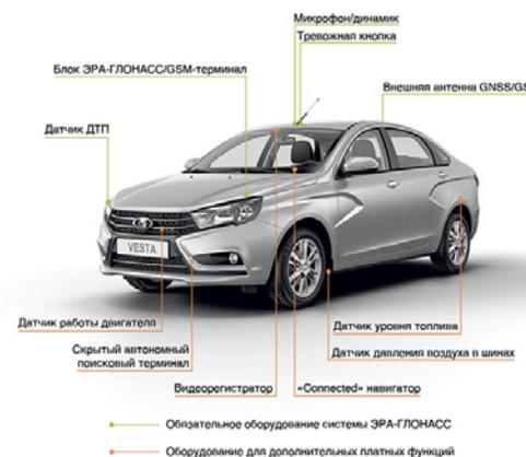
Рисунок 1 – Схема расположения датчиков и блока «ЭРА–ГЛОНАСС»
