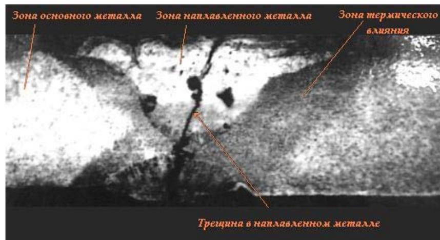
Рисунок 2 - Рентгенограмма сварного шва
