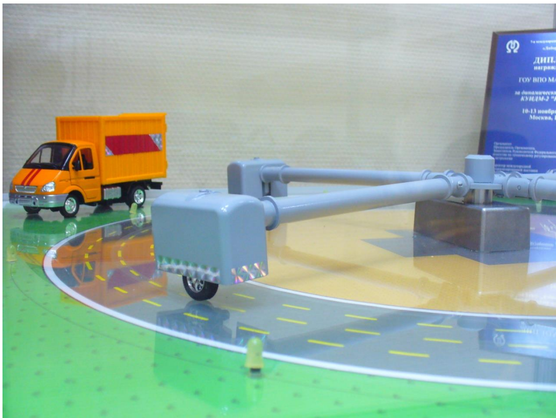
Рис. 2. Макет комплекса универсальных испытаний дорожных материалов КУИДМ-2 «Карусель»
