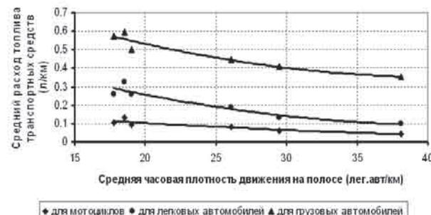
Рис. 3. Зависимость среднего расхода топлива транспортных средств от средней часовой плотности движения на полосе.
