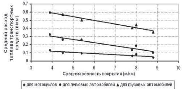
Рис. 7. Зависимость среднего расхода топлива транспортных средств от средней ровности покрытия.
