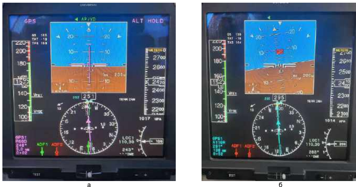
Рис. 2. Показания на мониторе PFD (primary flight display) при правом боковом ветре 13 узлов в случае прямолинейного полета без крена и скольжения (а) и в случае прямолинейного полета при правом крене 10° со скольжением (б)
