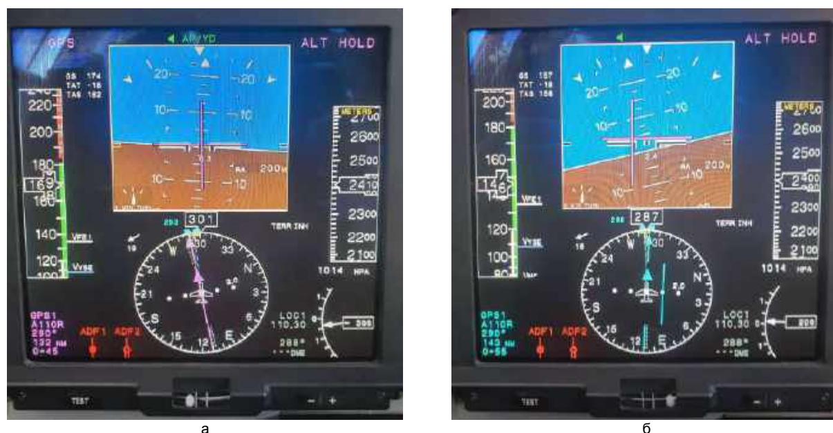
Рис. 3. Показания на мониторе PFD (primary flight display) при правом боковом ветре 19 узлов в случае прямолинейного полета с левым креном 5° со скольжением (а) и при правом боковом ветре 18 узлов в случае прямолинейного полета при правом крене 12° со скольжением (б): у самолета левое боковое отклонение 1 миля – расстояние между силуэтом самолета и находящейся справа голубой линией
