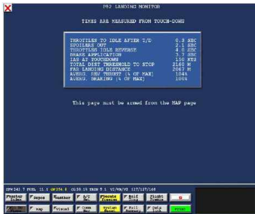
Рис. 3. Пример измерения времени реакции пилота на мониторе рабочего места инструктора FFS B-747-8
