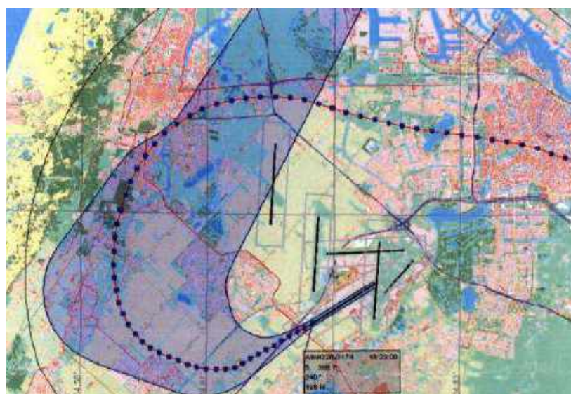
Рис. 1. Нормативно допустимый коридор для выхода из аэродромной зоны аэропорта Амстердама (пространство, окрашенное синим) и фактическая траектория движения B-747-200 (пунктирная линия)
