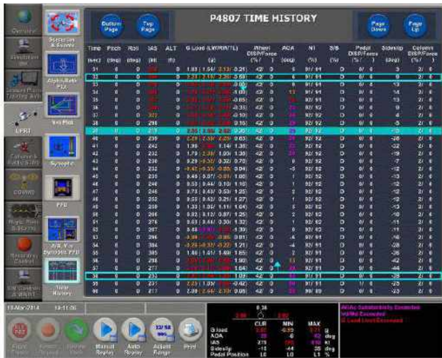
Рис. 2. Пример посекундных кадров для исследования координат X, Y, Z на мониторе рабочего места инструктора FFS B-747-8
