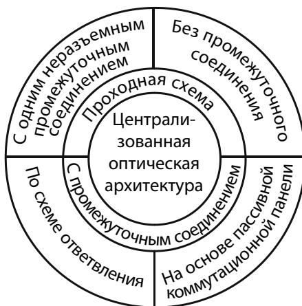
Рис. 6.3. Варианты построения централизованной оптической архитектуры МКС
