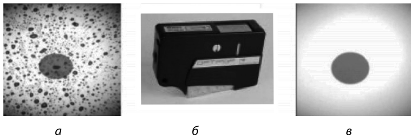
Рис. 5.4. Результаты очистки торца волокна:
