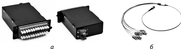
Рис. 6.9. Интерфейсные средства между разъемами МРО и LC или SC: а — Кассета 2×МРО(12) — 24×LC, OM4, 24-портовая, вид спереди и сзади; б — fanout -сборка 1×МРО(12) — 12×LC, OM3
