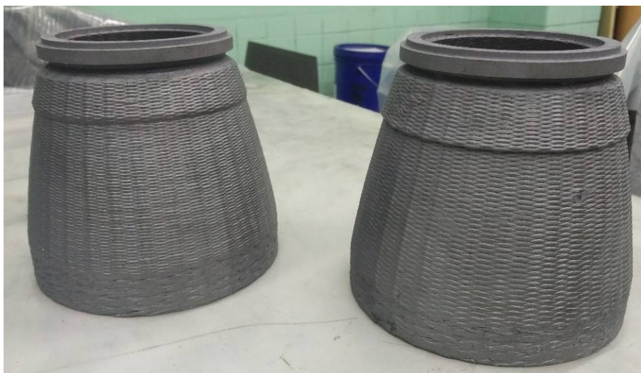
Рисунок 7 – Плетеные преформы изготовленные с постоянной поверхностной плотностью
