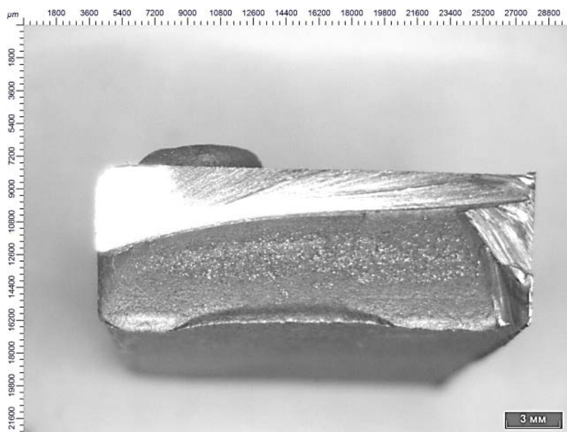
Рисунок 1 – Излом плавки № 27 из стали 35ХГСЛ (раскислитель СК30)
