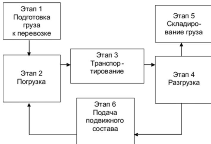
(!) Технологическая схема процесса перевозки груза одним видом транспорта
