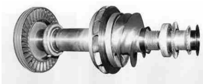
Рис. 2. Вал турбонасосного агрегата с турбиной
