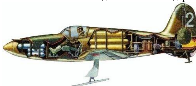
Рис. 1. Компоновочная схема реактивного самолета БИ-1
